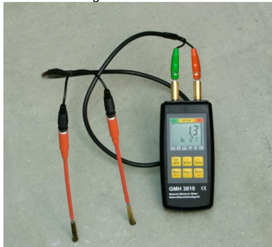
Betonmessung mit Bürstensonnen GBSL91
