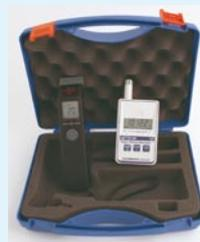
Mit dem im **GFTB 100 SET** zusätzlich enthaltenen Infrarot-Thermometer ist es darüber hinaus möglich, zum Schimmelbefall neigende Problemzonen an Wänden etc. mühelos zu erkennen.
