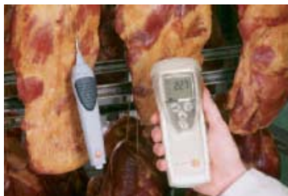
Kerntemperatur-Bestimmung beim Räuchervorgang, kabellos, Messdatenübertragung per Funk
