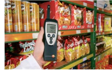
Abb. 10: Feuchtigkeitsmessung im Supermarktregal
