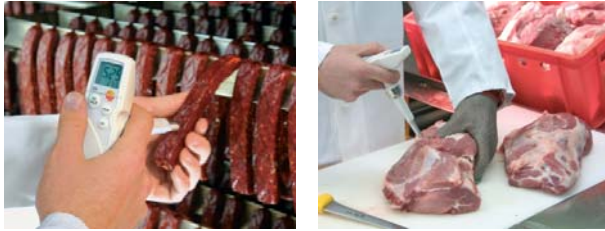
Abb. 9: pH-Wertmessung an Fleisch- und Wurstwaren
