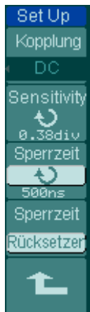
Abbildung 2- 63 Tabelle 2- 39 Das Trigger Setupmenü (Einstellungen für Trigger Kopplung, Triggersensivität und Sperrzeit)
