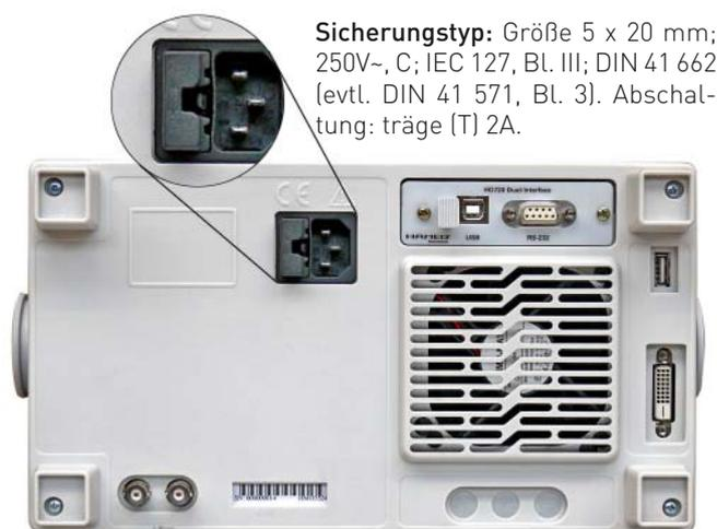
**Sicherungstyp:** Größe 5 x 20 mm; 250V~, C; IEC 127, Bl. III; DIN 41 662 (evtl. DIN 41 571, Bl. 3). Abschaltung: träge (T) 2A.
