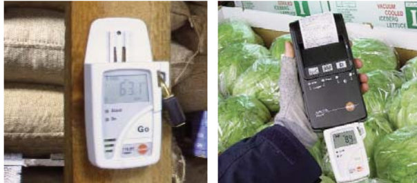
Abb. 7: Einsatz von Datenloggern
