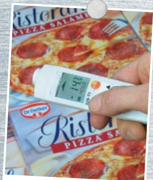
Oberflächentemperaturmessung z. B. beim Wareneingang
