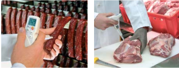
Abb. 9: pH-Wertmessung an Fleisch- und Wurstwaren
