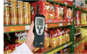
Abb. 10: Feuchtigkeitsmessung im Supermarktregal
