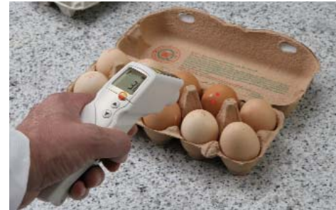
Abb. 5: Infrarot-Messung der Oberflächentemperatur an Nahrungsmitteln
