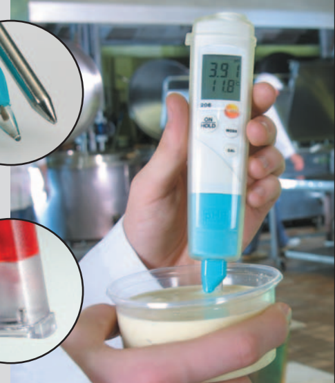
Stichproben pH-Kontrolle bei der Produktion von Dressing
