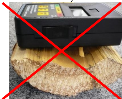
Falsch: Verworfene Oberfläche (hier extrem!)
