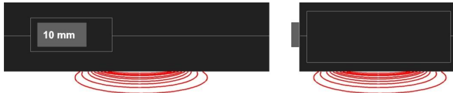
Seitenansicht: Messfeld und Eindringtiefe bei Schalterstellung „10 mm“
