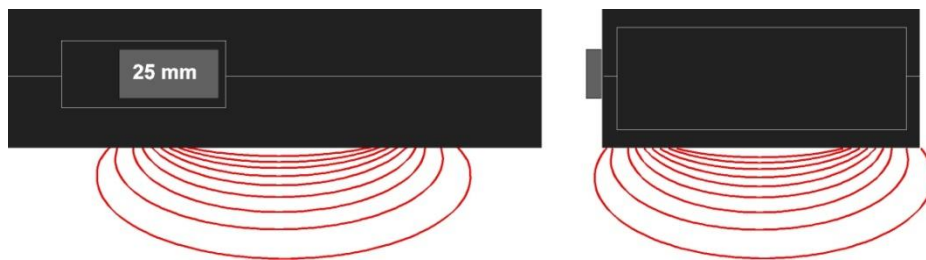
Seitenansicht: Messfeld und Eindringtiefe bei Schalterstellung „25 mm“
