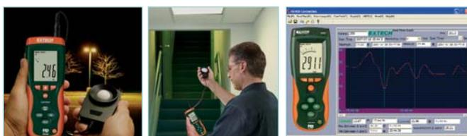
Ideal für Anwendungen in Innenräumen und im Freien zur Messung der Sicherheitslichtbedingungen in Übereinstimmung mit den OSHA-Richtlinien. Software zur Datenanalyse enthalten.
