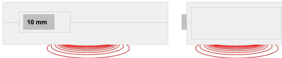
Seitenansicht: Messfeld und Eindringtiefe bei Schalterstellung „10 mm“
