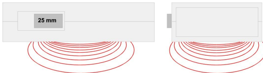
Seitenansicht: Messfeld und Eindringtiefe bei Schalterstellung „25 mm“
