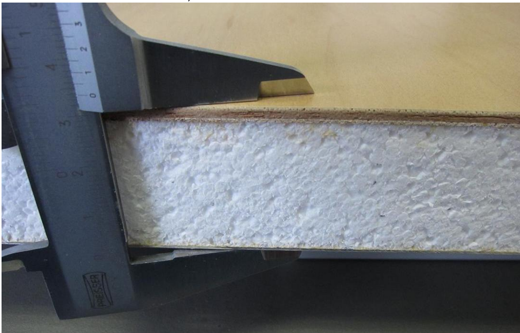
Beispiel Sandwich: Aluminium- Isolation - Sperrholz
