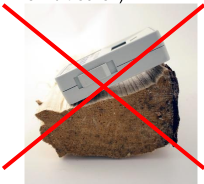
Falsch: Verworfene Oberfläche (hier extrem!)
