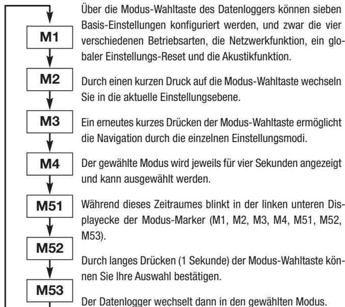
Erfolgt innerhalb des Vier-Sekunden-Zeitraumes keine Bestätigung der Auswahl, wird die Einstellungsebene verlassen und die Anzeige wechselt unverändert in den ursprünglichen Modus.
