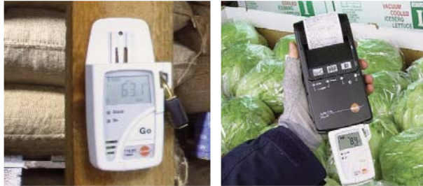
Abb. 7: Einsatz von Datenloggern
