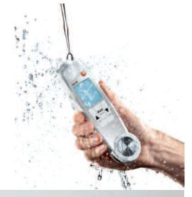
Das testo 104-IR ist ein wasserdichtes (IP65) Kombi Infrarot- und Einstechthermometer. Insbesondere beim Wareneingang scannen Sie berührungslos mit testo 104-IR die Oberflächentemperatur einzelner Produkte oder ganzer Warenpaletten. Wird dabei ein Grenzwert über- oder unterschritten, ermöglicht der Einstechfühler zusätzlich die Kerntemperaturmessung. Damit räumen Sie alle Zweifel aus.
