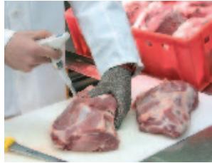
Abb. 9: pH-Wertmessung an Fleisch- und Wurstwaren
