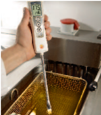
Abb. 12: Messung des TPM-Wertes in Frittieröl mit dem testo 270
