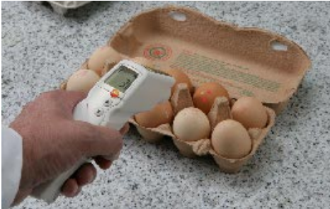
Abb. 5: Infrarot-Messung der Oberflächentemperatur an Nahrungsmitteln
