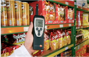
Abb. 10: Feuchtigkeitsmessung im Supermarktregal
