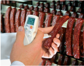
Abb. 9: pH-Wertmessung an Fleisch- und Wurstwaren
