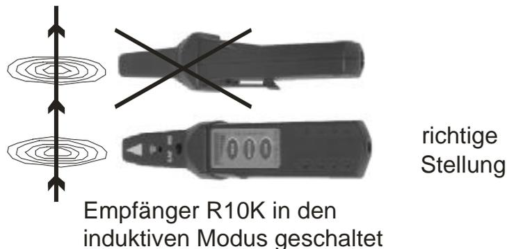
**Bild 4:** Erkennung eines elektromagnetischen Feldes
