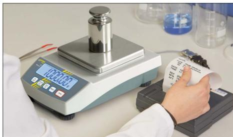
**GLP/ISO-Protokollierung** von Wägedaten, Waagenjustage etc. mit Datum, Uhrzeit und Ident-Nr. in Verbindung mit dem passenden KERN-Drucker. Ideal zum Überwachen und Dokumentieren Ihrer Prozesse gemäß Ihres Qualitätsmanagementsystems
