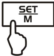
Die Prozentbestimmung ermöglicht die Gewichtsanzeige in Prozent, bezogen auf ein Referenzgewicht, das 100 % entspricht.
