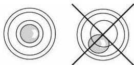
Die Waage mit Fußschrauben nivellieren, bis sich die Luftblase in der Libelle im vorgeschriebenen Kreis befindet.
