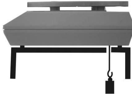
Abb. 1: Einrichten der Waage für Unterflurwägungen
