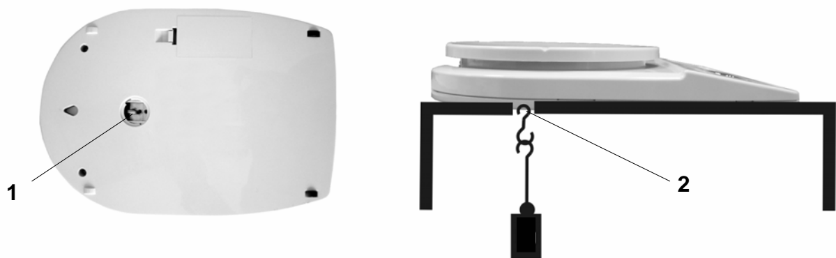
Abb. 1: Einrichten der Waage für Unterflurwägungen
