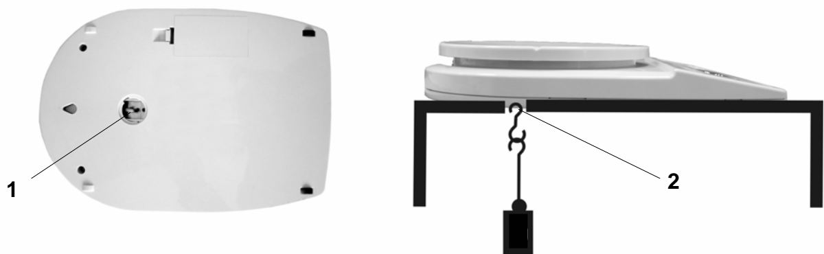
Abb. 1: Einrichten der Waage für Unterflurwägungen
