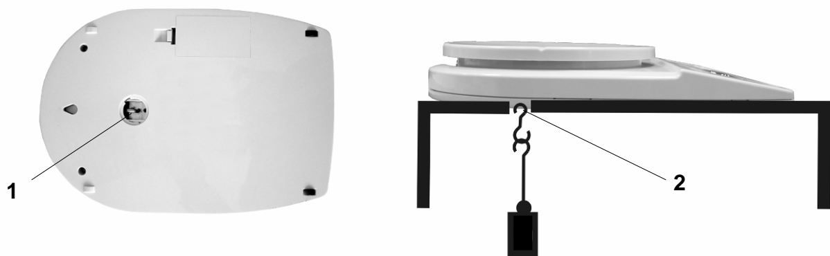
Abb. 1: Einrichten der Waage für Unterflurwägungen
