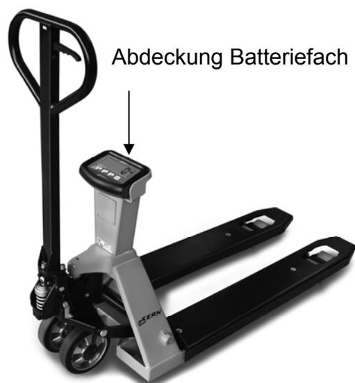
Zum Batteriewechsel die Abdeckung des Batteriefachs auf Rückseite des Anzeigege­rät­es abschrauben und entfernen. Verbrauchte Batterien gegen neue (4 x 1,5V AA Batterien) austauschen (auf richtige Polung achten) und Batteriedeckel wieder ein­setzen.
