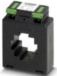
Aufsteckstromwandler, Primärstrom 750 A AC; Sekundärstrom 5 A AC; Genauigkeitsklasse 1; Bemessungsleistung 10 VA
