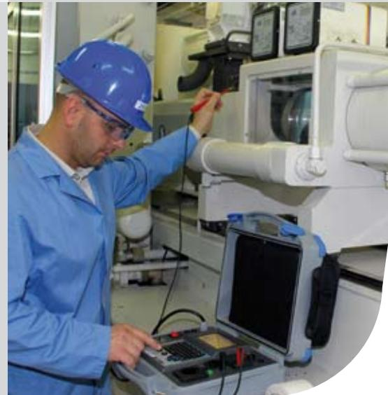
Das tragbare Mehrfunktions-Prüfgerät MultiservicerXA überprüft die Sicherheit an elektrischen Maschinen (VDE 0113), ortsveränderlichen Geräten (DIN VDE 701-702) und Schaltschränken (VDE 0660/500).
