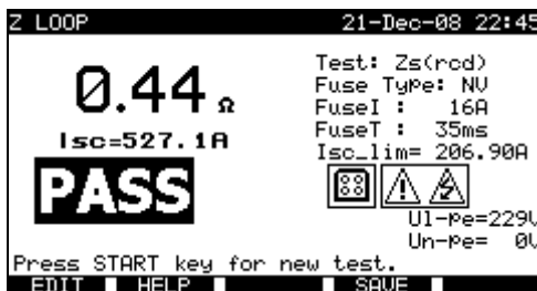
Beispiele von Ergebnissen der Messung der Fehlerschleifenimpedanz
