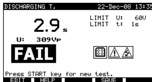
Beispiele für Messergebnisse der Entladezeit
