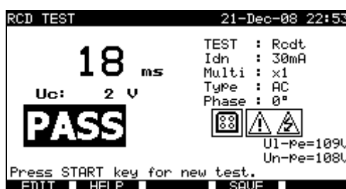
Beispiel für Messergebnisse der RCD-Auslösezeit
