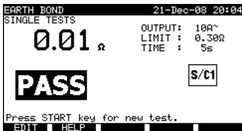
Beispiele von Ergebnissen der Messung des Schutzleiterwiderstands
