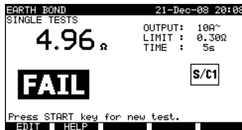
Beispiele von Ergebnissen der Messung des Schutzleiterwiderstands
