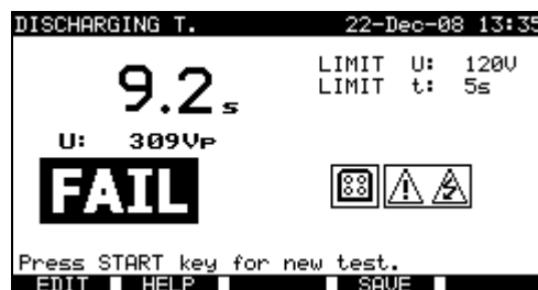
Beispiele für Messergebnisse der Entladezeit
