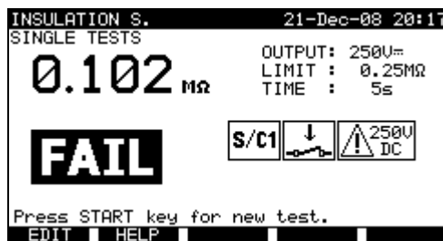
Beispiel von Ergebnissen der Messung des Isolationswiderstands-S
