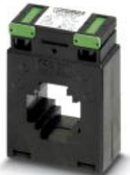
Aufsteckstromwandler, Primärstrom 400 A AC; Sekundärstrom 5 A AC; Genauigkeitsklasse 1; Bemessungsleistung 10 VA
