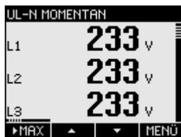
Bild 3-1 Anzeige der Messspannung bei Anschlussart 3P4W
