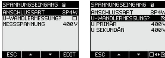
Bild 9-4 Geräteeinstellung "SPANNUNGSEINGANG"
