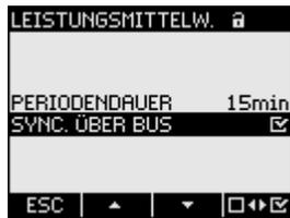
Bild 9-6 Geräteeinstellung "LEISTUNGSMITTELWERTE"
