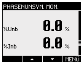
Bild 3-11 Unsymmetrie von Spannung und Strom
