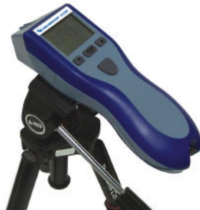
Montage des Laser-Tachometers auf einem Stativ
