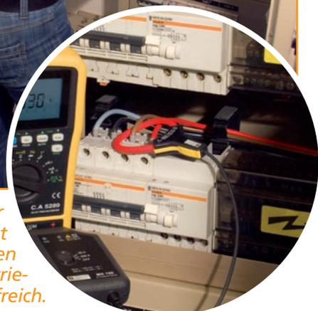
Die Flexibilität der Stromwandler ist besonders bei Messungen an Schalttafeln im Industrie- und Wohnbereich hilfreich.
