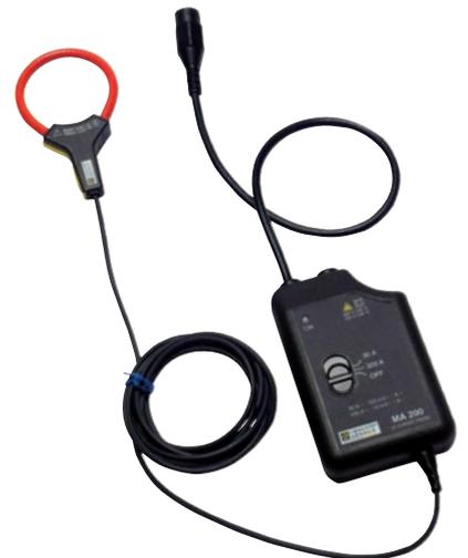
Die flexiblen AmpFLEX™ und MiniFlex-Stromwandler beruhen auf dem Prinzip der Rogowski-Spule in Verbindung mit einer Mess-Elektronik. Da keine magnetischen Kreise beteiligt sind, sind die Stromwandler leicht und flexibel und es kommt zu keinen Sättigungs-Erscheinungen, d.h. auch nicht zu Erwärmungen. Daher sind diese Stromwandler sehr linear und erzeugen nur geringe Phasenverschiebungen.
