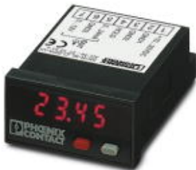
Digitaler-Sollwertgeber mit manueller und automatischer Rampe zur Vorgabe von Strom und Spannungssignalen, 4-stellige Anzeige
