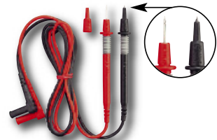
Ø 4 mm Sicherheitsmessleitungen mit 4 mm Messspitze Art.-Nr. 044145 Empf. VK 16,20 €* Ø 4 mm Sicherheitsmessleitungen, 2-teilig, rot/schwarz, L = 1,40 m, mit 4 mm Messspitze, CAT IV 600 V / CAT III 1000 V (mit Schutzkappen), CAT II 1000 V (ohne Schutzkappen)
