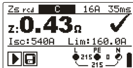
Bild 5.25: Beispiele für Messergebnisse der Schleifenimpedanz
