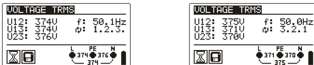
Bild 5.4: Beispiel für eine Spannungsmessung im Drehstromnetz
