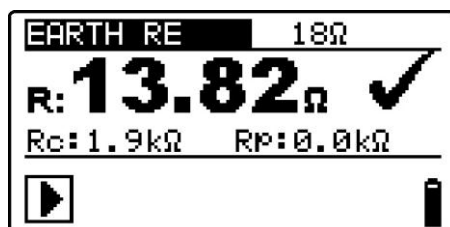
Bild 5.35: Beispiel eines Ergebnisses der Erdungswiderstandsmessung
