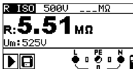
Bild 5.7: Beispiel für ein Ergebnis einer Isolationswiderstandsmessung
