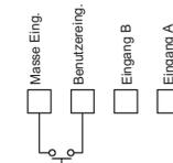
Der Benutzereingang wird über einen potentialfreien Kontakt aktiviert. Intern wird der Benutzereingang über einen 10 KOhm-Widerstand auf 9-28 VDC hochgezogen. Der Eingang ist aktiv, wenn er auf Low geschaltet (<1 VDC) wird.
