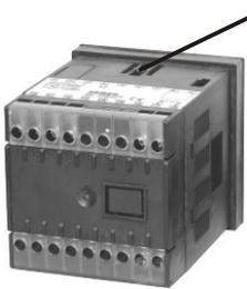
Drücken Sie mit dem Daumen (keine scharfkantige Werkzeuge benutzen) die Frontplatte (abwechselnd oben und unten) aus der Gehäuse heraus. Wenn sich die Frontplatte mit den befestigten Platinen sich intern von den Buchsen gelöst hat, den oberen und unteren Bolzen nach innen drücken und die Frontplatte (mit Platinen) aus der Gehäuse herausziehen.
