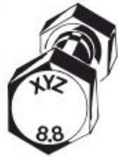
**Kennzeichnung von Gewindestücken nach DIN 976 (Gewindestangen nach DIN 975)** werden mit der Festigkeitsklasse ab 5.6 gekennzeichnet. Das Herstellerkennzeichen ist nicht erforderlich. Alternativ ist folgende Farbkennzeichnung:
