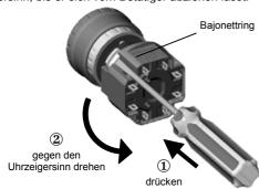
Hinweis: Wenn der Kontaktblock abgenommen ist, werden die Hauptkontakte geöffnet und der Hilfskontakt geschlossen.
