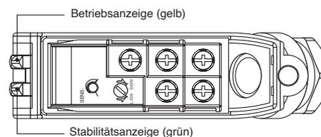
Die Betriebsanzeige (gelb) leuchtet, wenn der Überwachungsausgang geschaltet wird. Die Stabilitätsanzeige (grün) leuchtet, wenn ein stabiler Zustand erkannt wird (Signaleingang oder -unterbrechung). Verwenden sie die Lichtschranken der SA1U-Baureihe nur, wenn die Stabilitätsanzeige grün leuchtet. Dazu diese Tabelle:
