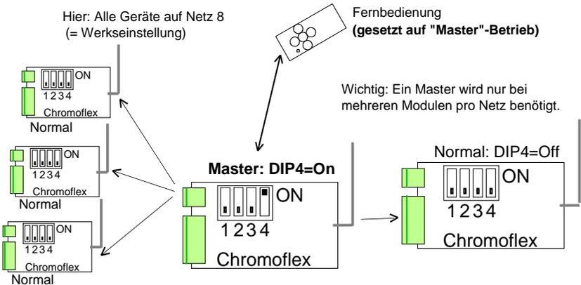
In der Zeichnung sind ein einziges Modul und die Fernbedienung auf „Master“ gesetzt. Somit kann nur der Master auf die Fernbedienung reagieren. Der Master sendet seine Einstellungen periodisch an alle anderen Module.
