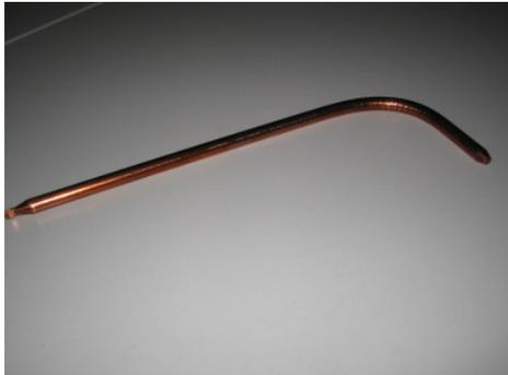
Ein geeignetes Werkzeug ist z. B. eine Rohrbiegezange, die ein Profil hat, das genau dem Durchmesser der Heatpipe entspricht. Die Verwendung eines Profils mit einem größeren Durchmesser kann zum Knick in der Heatpipe und damit zum möglichen Funktionsverlust führen.
