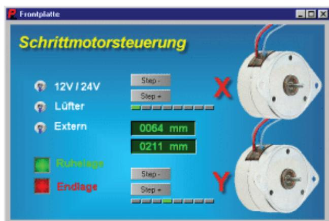
Hier sehen Sie ein Beispiel für eine Frontplatte, die mit ProfiLab erstellt wurden. Durch das kombinieren von Bitmaps mit den Bedienungs- und Anzeigeelementen der Software sind Ihrer Fantasie kaum Grenzen gesetzt.
