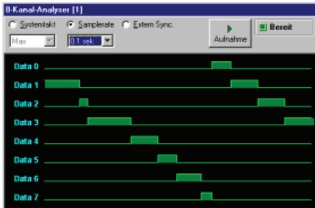
automatisch. Verschiedene Tools wie die Anzeige der logischen Zustände während der Simulation, oder der integrierte Logik-Analyser helfen Ihnen Fehler in Ihrer Steuerung aufzuspüren, oder veranschaulichen die Funktionsweise Ihrer Schaltung.
