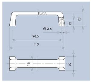
vorgesehen für z. B. Flachkopf-Blechschrauben. Provided f. e. pan head tapping screws.
