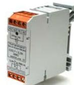
Achtung !!! Es wird am Lastausgang nur die Lastphase über die Klemmen 3 und 4 durchgeschleift !!
