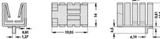
mit verzinnter Lötflanke zum direkten Einlöten auf der Leiterkarte für horizontale Einbaulage
