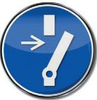
Schließen Sie das Bauteil nur an Stromkreise an, die mit einem **allpoligen** trennenden Schalter abschaltbar sind.
