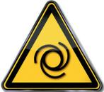
Bei angelegter Spannung läuft der Motor nach Netzausfall oder Beseitigung der Blockierung automatisch wieder an. Halten Sie sich nicht im Gefahrenbereich des Bauteils auf. Schalten Sie bei Arbeiten am Bauteil die Netzspannung aus und sichern Sie es gegen Wiedereinschalten.
