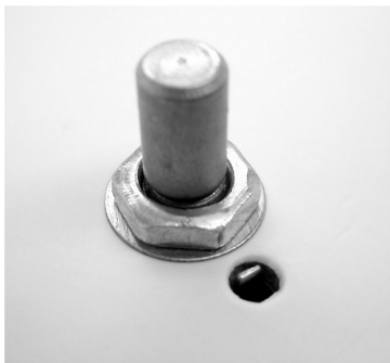
Der Lautstärkereglер (Poti) mit Schalter
