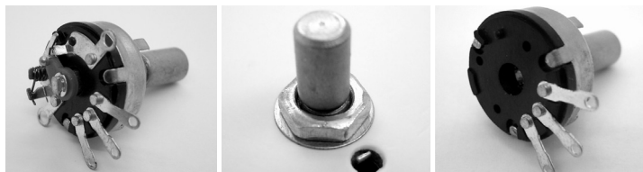
Lautstärkeregler mit Schalter und Rückkopplungsregler (Potis)
