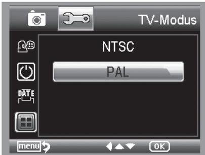
Das Gerät verfügt über einen AV-Ausgang, an den man einen Fernseher anschließen kann. Stellen Sie für Europa die Fernsehnorm auf PAL.
