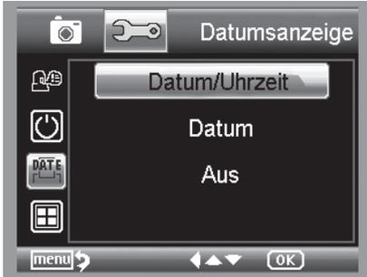
In dieser Einstellung kann festgelegt werden, ob das Datum und die Uhrzeit oder nur das Datum im Bild eingeblendet wird. Wenn Sie **Aus** gewählt haben, wird nichts im Bild eingeblendet.
