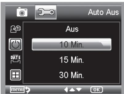
Wenn der Energiesparmodus **Auto Aus** eingeschaltet ist, schaltet sich das Gerät nach der eingestellten Zeit automatisch aus. Dadurch verlängert sich die Laufzeit der Batterie. Um den Energiesparmodus zu deaktivieren, wählen Sie **Aus**.
