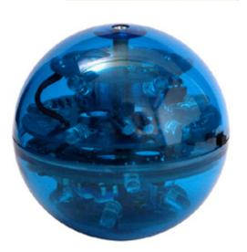
Zur Steuerung der Dioden enthält der Ball einen kleinen ATTiny Mikrocontroller.
