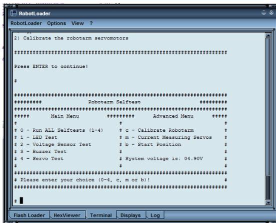
Sie können jetzt den Selbsttest und die Kalibrierung des Roboter Arms durchführen. Starten Sie dazu bitte das Programm mit einem Druck auf den Start/ Stop Reset Taster auf dem Roboter ARM Später können Sie das natürlich auch alternativ über das Menü RobotLoader --> Start oder die Tastenkombination [STRG]+[S] tun, so können Sie allerdings direkt ausprobieren ob der Taster korrekt funktioniert!
