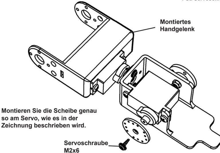
Montieren Sie die Scheibe genau so am Servo, wie es in der Zeichnung beschrieben wird.
