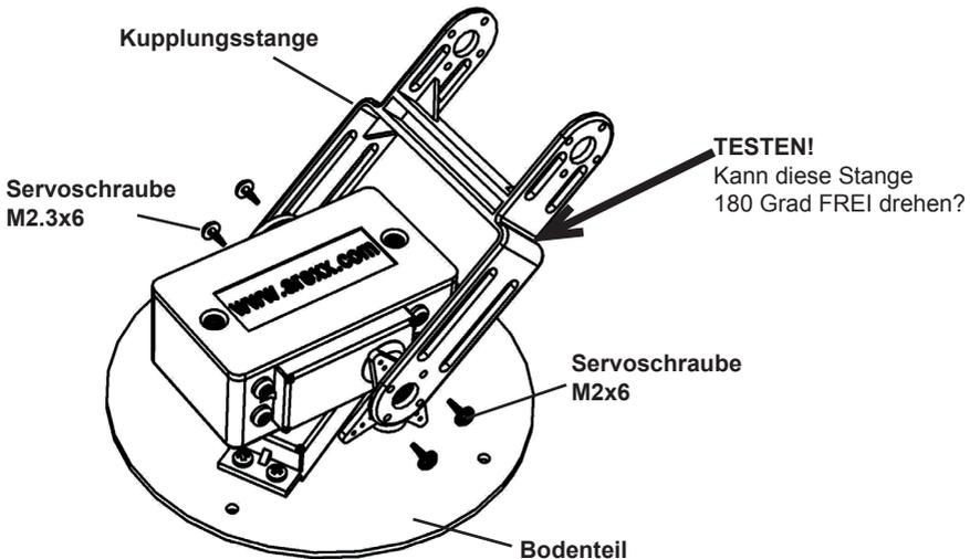
Montieren Sie den Servoarm genauso, wie es in der Zeichnung beschrieben wird.
