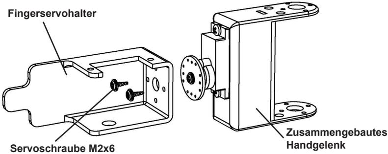
Montieren Sie den Fingerservohalter genauso, wie es in der Zeichnung beschrieben wird.
