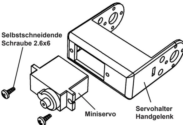
Montieren Sie den Handgelenkservo genauso, wie es in der Zeichnung beschrieben wird.
