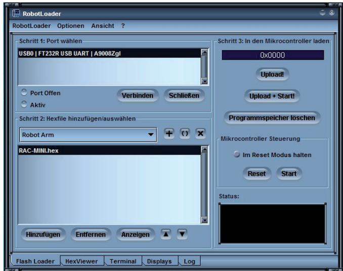
Falls kein USB Port in der Liste „Schritt 1: Port wählen“ erscheint stellen sie sicher, dass das Kabel verbunden ist und die Treiber des Programmiers adaptors installiert sind. Sie können die Portliste neu abfragen im Menü; **RobotLoader -> Portliste aktualisieren**. Wählen sie anschließend den Port aus und klicken sie auf verbinden.
