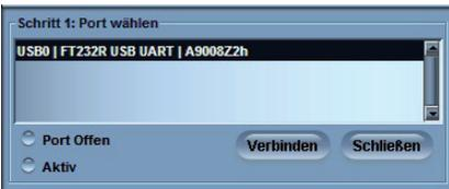
Jetzt können Sie den USB Port auswählen. Sofern kein anderer USB->Seriell Adapter mit FTDI Controller am PC angeschlossen ist, sehen sie in der Portliste nur einen einzigen Eintrag den Sie dann bitte auswählen.
