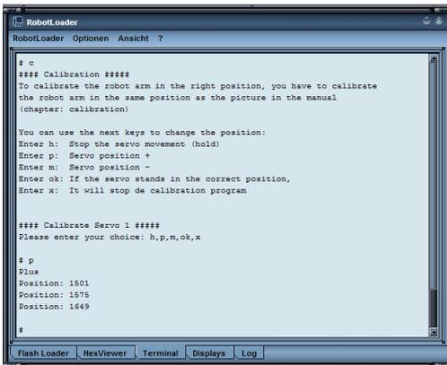
Drehen Sie alle Servomotoren in die Mittellage sodass der Roboter Arm aussieht wie auf Seite 47. Die Servomotoren 2-6 befinden sich dabei in etwa in der Mittellage und der Finger (Servo 1) ist fast geschlossen.
