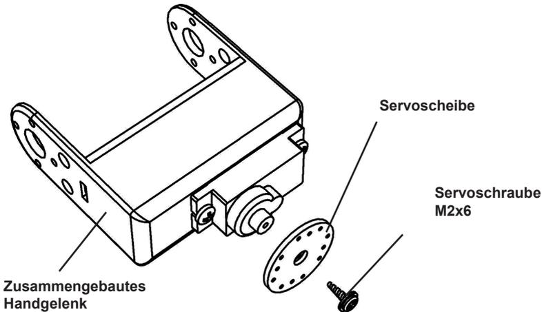
Montieren Sie die Servoscheibe genauso, wie es in der Zeichnung beschrieben wird.
