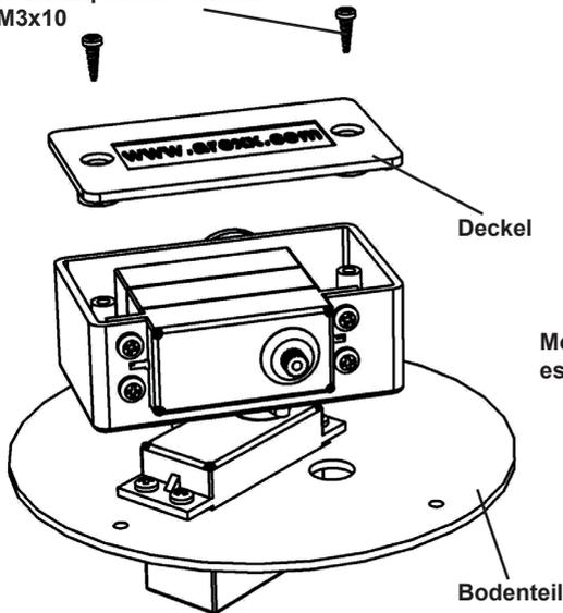
Montieren Sie den Deckel genauso, wie es in der Zeichnung beschrieben wird.
