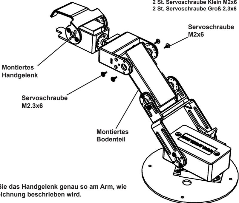
Montieren Sie das Handgelenk genau so am Arm, wie es in der Zeichnung beschrieben wird.
